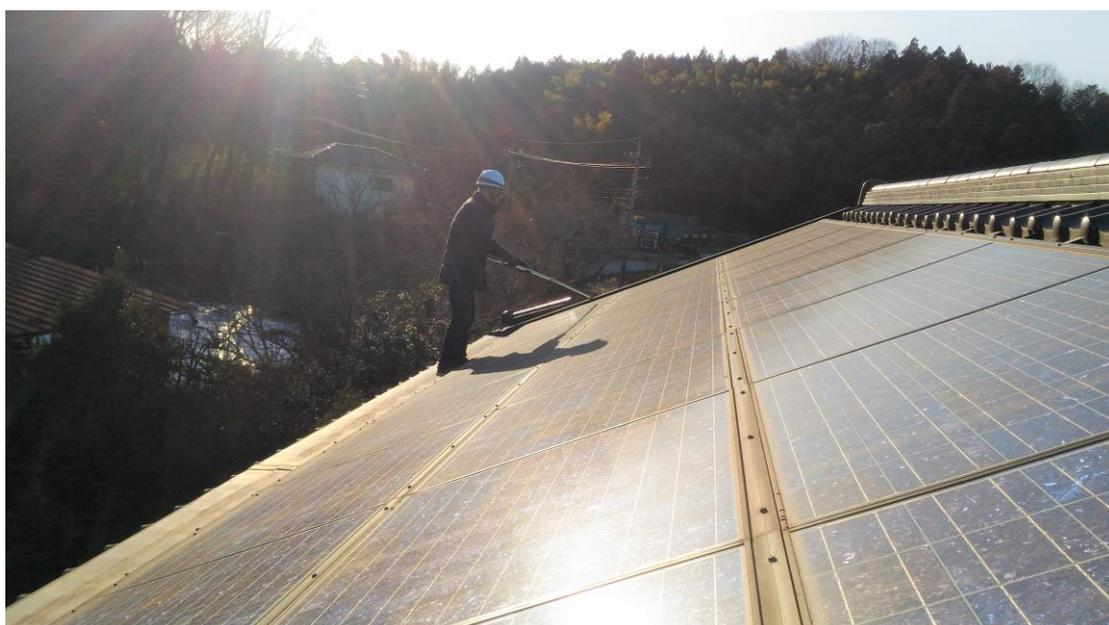
BPDのショート故障を検出できる専用測定器を使った調査
